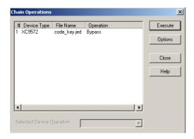
Hier wird nun die Zeile angeklickt. Und bei "Select Device Operation" Programm auswählen
