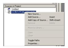
Nun die Files die zuvor in ORCAD simuliert wurden dazufügen. Hier wird noch abgefragt, ob es sich um VHDL Module (VHDL Modell) und VHDL Testbench angeben
