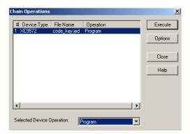
Jetzt kann die Programmierung der Hardware mit "Execute" durchgeführt werden. War alles erfolgreich erscheint folgender Kommentar. Jetzt kann der Funktionstest an der Hardware durchgeführt werden.
